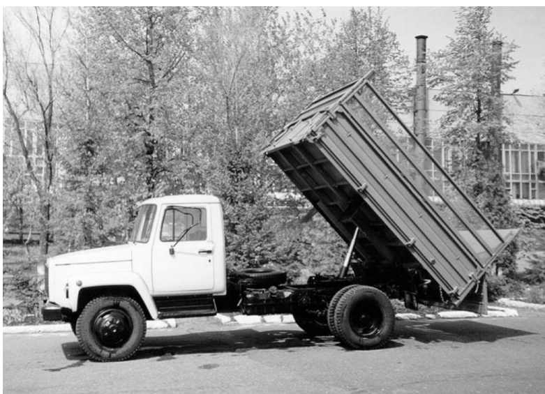
Рисунок 2 - Автомобиль-самосвал с платформой, на которую установлены надставные борта. Объем платформы – 10\text{ м}^3 .
