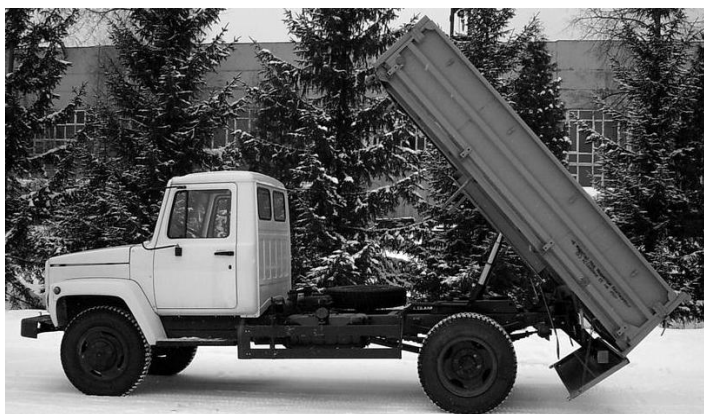
Рисунок 1 - Автомобиль-самосвал с платформой без надставных бортов. Объем платформы - 5\text{ м}^3 .
