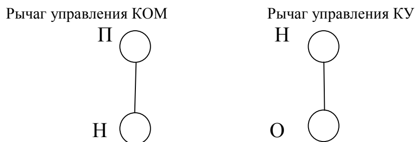
Рисунок 6 - Схема положений рычагов управления подъемом и опусканием платформы автомобиля-самосвала:
